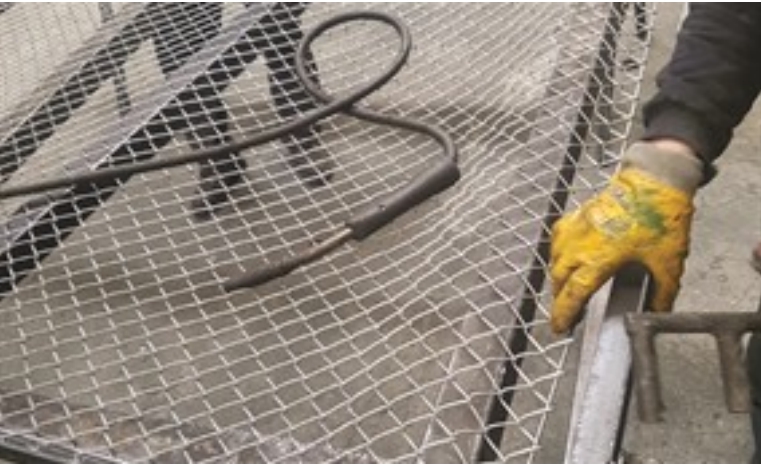
■ Detay ve projesine göre köşebent çerçeve içine galvaniz kaplı tel örgü malzemesinin fabrika ortamında yapılma işlemi.
